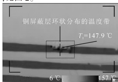
图 2 铜屏蔽层间隔缠绕加压后的表面温度分布
